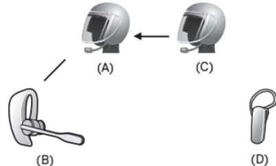
3. Der Teilnehmer mit dem Bluetooth-Headset eines anderen Herstellers (D) kann an der Konferenz über die Sprechanlage teilnehmen, indem er über die Sprechanlage den Benutzer des SC1 (C) anruft.
