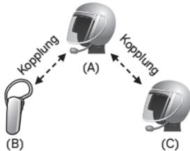
2. Starten Sie mit einem Bluetooth-Headset eines anderen Herstellers (B) die Kommunikation über die Sprechanlage in Ihrer Sprechanlagegruppe. Beispielsweise können Sie (A) über die Sprechanlage die Kommunikation mit dem Bluetooth-Headset eines anderen Herstellers (B) beginnen. Alternativ kann der Gesprächsteilnehmer mit dem Bluetooth-Headset eines anderen Herstellers (B) Sie (A) über die Sprechanlage anrufen.
