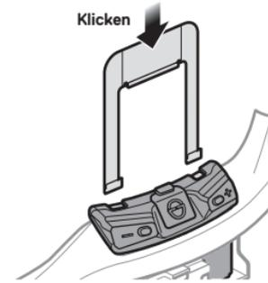
2. Ziehen Sie am Ausbauwerkzeug, bis sich die Haupteinheit aus dem Helm löst.
