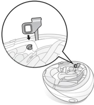
3. Stecken Sie die Haupteinheit zwischen die äußere und die innere Schale. Richten Sie die Schnellhalter auf die hinteren Befestigungen aus.
