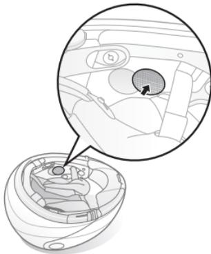
5. Befestigen Sie die Lautsprecher an den zugehörigen Klettverschlüssen an der Helminnenseite. Lassen Sie dann die Befestigungen in den Schnellhaltern einrasten.
