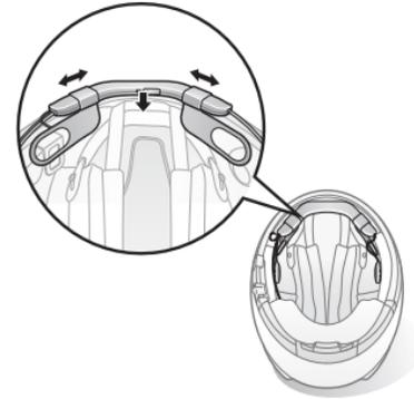
4. Ziehen Sie die Schutzfolie der Klettverschlüsse für die Lautsprecher ab, sodass jeweils die Seite mit der Klebefläche offen liegt. Bringen Sie die Klettverschlüsse an den Ohransparungen an der Helminnenseite an.
