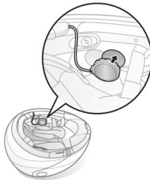
6. Fügen Sie die Steuertasten und das Mikrofon zwischen die äußere und die linke innere Schale ein. Lassen Sie die Befestigung im entsprechenden Schnellhalter einrasten.
