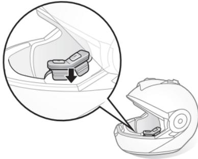
7. Stecken Sie die Kabel hinter die mittlere Polsterung und bringen Sie die Wangenpolsterung wieder an.
