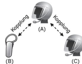
2. Starten Sie mit einem Bluetooth-Headset eines anderen Herstellers (B) die Kommunikation über die Sprechanlage in Ihrer Sprechanlagen Gruppe. Beispielsweise können Sie (A) über die Sprechanlage die Kommunikation mit dem Bluetooth-Headset eines anderen Herstellers (B) beginnen. Alternativ kann der Gesprächsteilnehmer mit dem Bluetooth-Headset eines anderen Herstellers (B) Sie (A) über die Sprechanlage anrufen.
